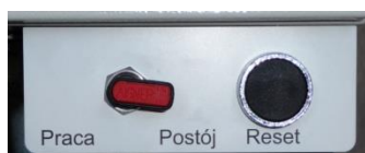
Zawór postoju wraz z przyciskiem resetu
